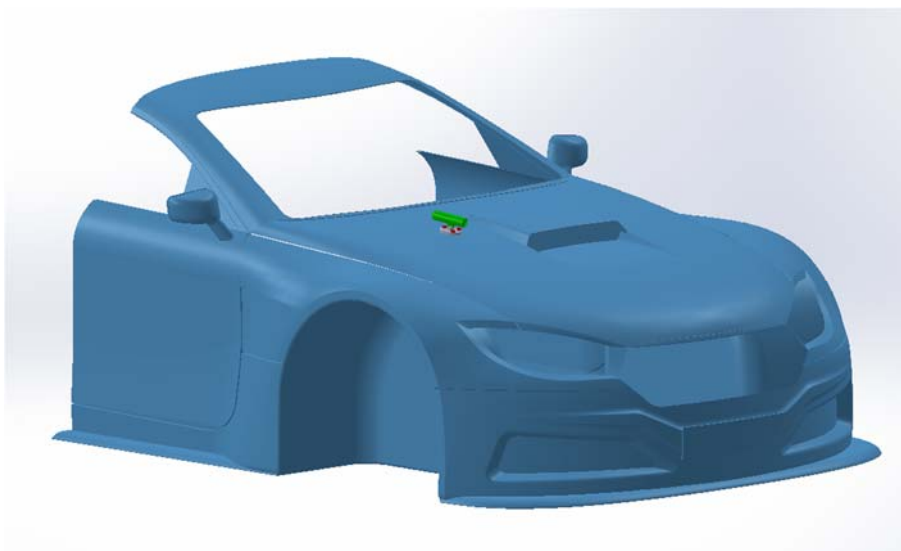
Cámara cilíndrica sobre una superficie, unión tornillo-tuerca
